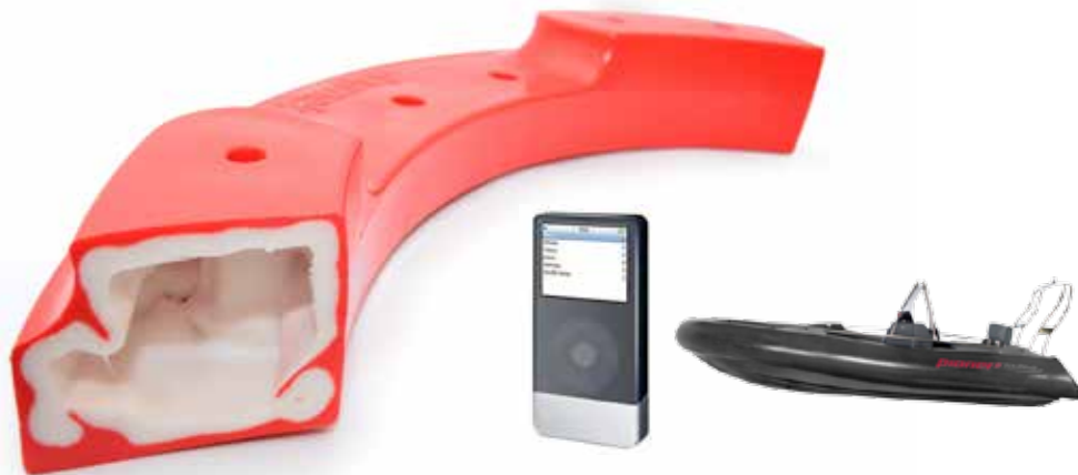
Tversnitt av designet polymer. Oppskummet for økt stivhet
